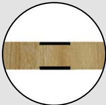
SZKŁO LACOBEL WKLEJANE W PŁYTĘ HDF, zlicowane z powierzchnią skrzydła czarne
